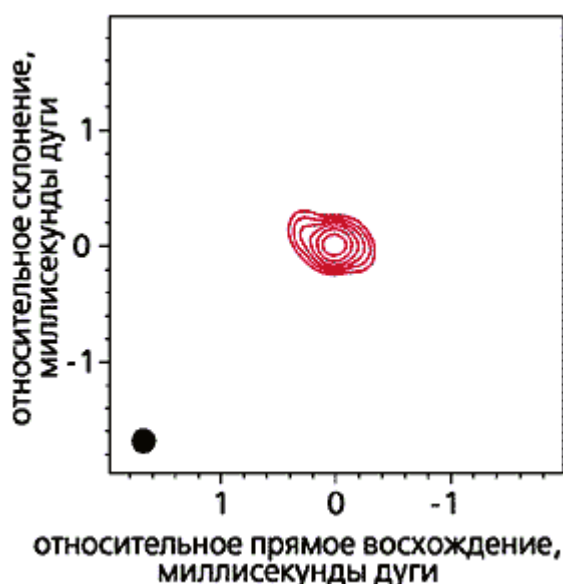
Рис. 10. Радиоизображение области центра нашей Галактики с угловым разрешением 2 \cdot 10^{-4} ", полученное на волне 3.5 мм методом радиоинтерферометрии со сверхдлинной базой [8]. Темное пятно в левом нижнем углу характеризует размер диаграммы направленности радиоинтерферометра. Видно, что центральная черная дыра массой 4 \cdot 10^6 M_\odot окружена оболочкой из плазмы, излучающей в радиодиапазоне, радиус которой составляет 1 а.е.
